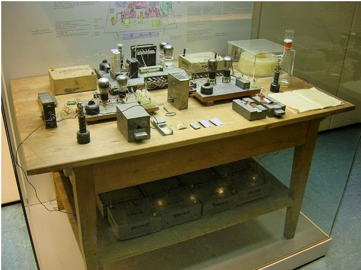
Laboranordnung zur ersten Uranspaltung
